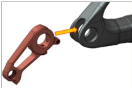
Bitte vergewissern Sie sich vor der Montage des neuen Schaltauges, dass der Montagepunkt sauber und unbeschädigt ist. Führen Sie das Ausfallende in die Aufnahme.
