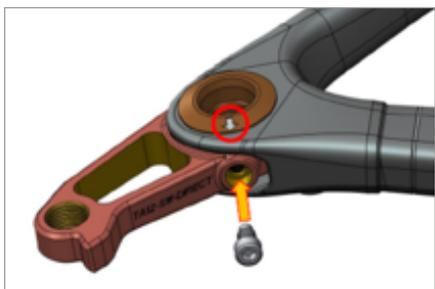
Bitte vergewissern Sie sich, dass die Markierung der Gewindebuchse in Richtung des Befestigungsbolzen zeigt. Befestigen Sie den Bolzen mit einem max. Drehmoment von 1.5Nm.
