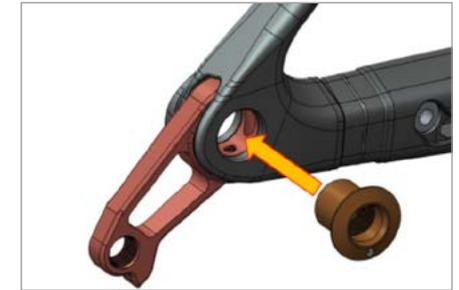
Schieben Sie die Gewindebuchse von außen durch die Rahmenbohrung und das Ausfallende.
