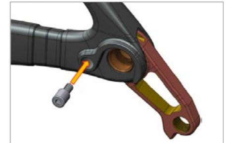
Bitte montieren Sie den 2ten Befestigungsbolzen an der Rückseite des Ausfallendes mit einem max. Drehmoment von 1.5Nm.
