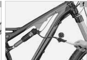
**⚠ GEFAHR:** Bei vollgefederten Rahmen ist der Hinterbau so ausgelegt, dass er Schläge ausgleichen kann bzw. muss. Ist das Federbein starr und blockiert, gehen Schläge ungemindert in den Rahmen. Dadurch können das Federbein selbst und der Rahmen Schaden nehmen. Deshalb dürfen Sie bei Federbeinen mit Lockout-Mechanismus diese Funktion generell nur auf glattem Terrain (Straßen, Feldwege) betätigen und nicht in grobem Gelände.
