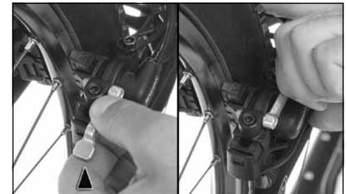
4. **Achten Sie darauf, dass die Bremsgummis bei Bremsbetätigung korrekt die Felgenflanken bedecken.**
