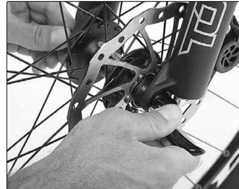
5. Drehen Sie die Schraubenmutter bzw. den Innensechskant nun soweit, bis sich der exzentrisch gelagerte Hebel bei einer Drehung um seine Lagerung ab 90° nur noch gegen einen Widerstand bewegen lässt (er bildet so die ungefähre, geradlinige Verlängerung der Nabenachse).
