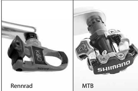
**Bei Klickpedalen sind Schuh und Pedal in vertikaler Richtung fest verbunden. Man kann also das Pedal beim Treten nicht nur nach unten drücken, sondern auch nach oben ziehen.**
