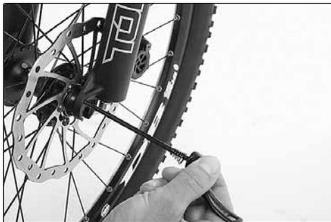
2. Setzen Sie die Feder und die Schraubenmutter auf die Achse. Drehen Sie auf das rechte Ende, das jetzt aus der Nabe heraussteht, die Schraubenmutter im Uhrzeigersinn.
