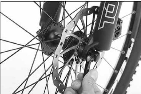
2. Drehen Sie die Schraubenmutter soweit gegen den Uhrzeigersinn bis sich das Laufrad ohne großen Kraftaufwand aus dem Rahmen bzw. aus der Vorderradgabel nehmen lässt.
